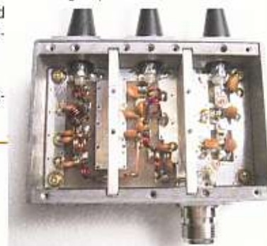
Triplexer voor groot vermogen (800 W HF/VHF, 300 W UHF, 150 W SHF, vswr<1.2).
